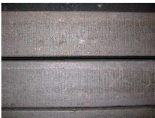
Figura 3. Superfície de um aço inoxidável produzido no lingotamento contínuo. Seção 145x145 mm 2 .
