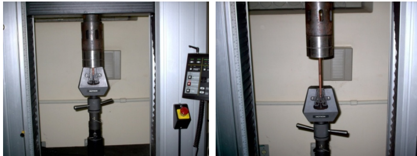
Figura 1. Dispositivo montado para a trefilação em máquina de ensaio universal.
