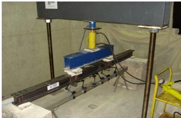
d) Esquema de ensaio e posição dos defletômetros
