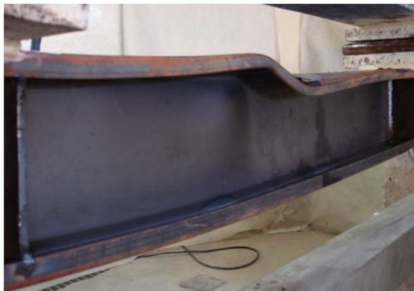
**Figura 4** – Ruptura por distorção da seção transversal– Vigas da série VB.
