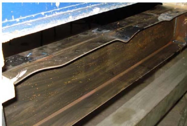
**Figura 3** – Formação de meia ondas senoidais indicando a flambagem local da mesa – Vigas da série VA.
