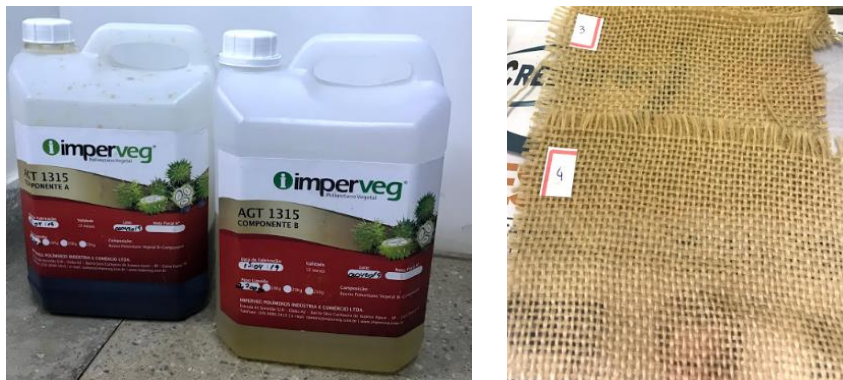
Figura 1. (a) Resina PU Vegetal utilizada, (b) Tecido de Juta utilizado.
