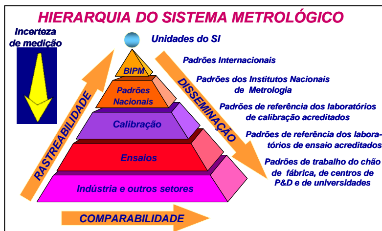
Figura 1. Cadeia de rastreabilidade, que é válida para qualquer grandeza, incluindo Dureza, mostrando o interrelacionamento entre rastreabilidade, comparabilidade, disseminação da confiabilidade nas medições e incerteza de medição. (3)
