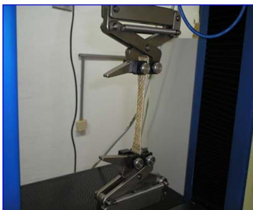
**Figura 3:** Ensaio de Tração.
