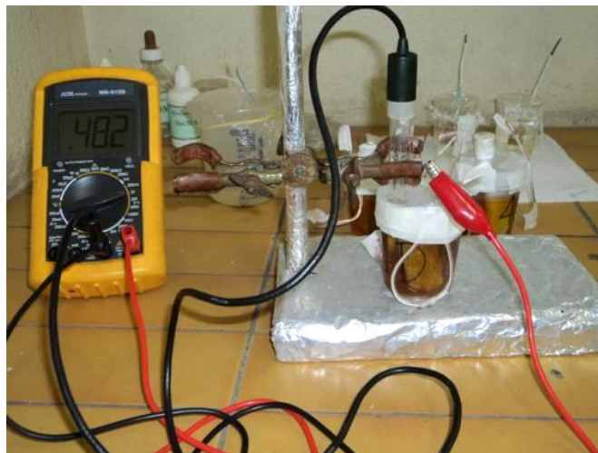
Figura 1 - Dispositivo montado para as medições do ensaio de potencial em circuito aberto.
