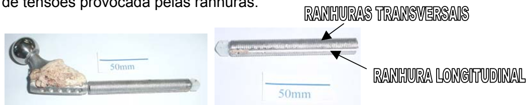
Figura 2. Fotografias da prótese modular fraturada. Observa-se a presença de material orgânico, cimento ósseo e as ranhuras para maior estabilidade.
