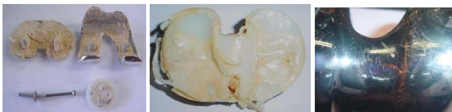
Figura 9. Na imagem à esquerda observamos microesferas aderidas junto ao cimento ósseo nas interfaces. Abaixo um parafuso deformado e a patela. À direita observamos a presença de cimento ósseo junto à parte polimérica da bandeja. Macrografia mostrando o desgaste na superfície do componente femoral que fazia contato com a mesma.
