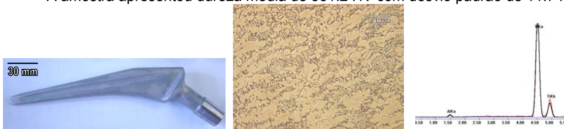
Figura 8. Imagem da prótese modular de titânio com acabamento fosco. Micrografia da amostra com grãos refinados da fase alfa (claros) e fase beta. Ataque com reagente à base de ácido fluorídrico e ácido clorídrico. Espectro de microsonda mostrando os picos relacionados ao titânio, elemento majoritário, e alumínio, o elemento de liga.
