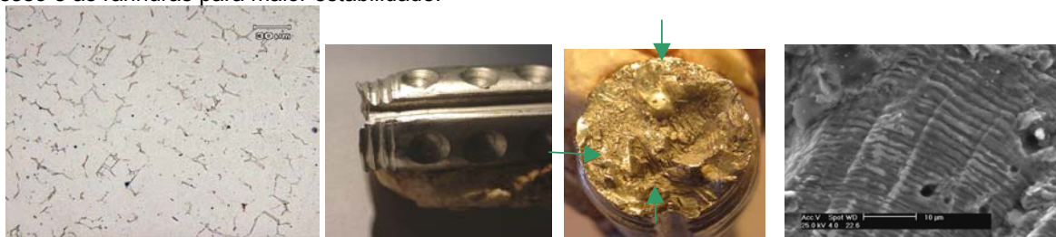
Figura 3. Micrografia da amostra mostrando que a microestrutura é bruta de fusão contendo ilhas de ferrita e carbeto em uma matriz austenítica. Imagens mostrando a ruptura da prótese junto a um dos filetes transversais (aumento de 4x), os diferentes pontos de nucleação, indicados por setas (aumento de 5x) e as estrias de fadiga, respectivamente.
