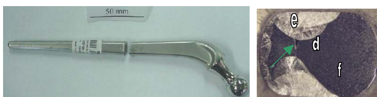
Figura 4. Imagem mostrando a prótese como recebida, com o plano de fratura na haste. As marcas de deformação superficiais foram produzidas na operação de revisão. Macrografia da seção transversal onde observamos metal depositado por solda e a chapa unida à haste. A seta indica uma cavidade interna por falta de penetração de solda.
