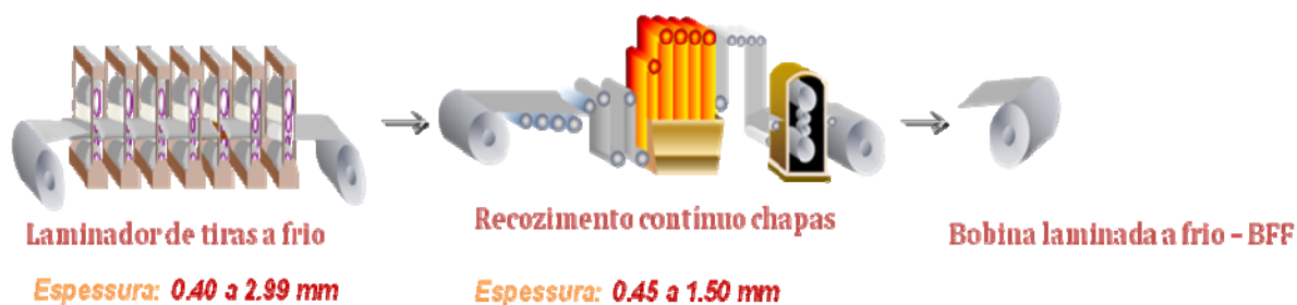
Figura 1. Fluxo de produção convencional de bobinas para o setor de utilidades domésticas. (1)
