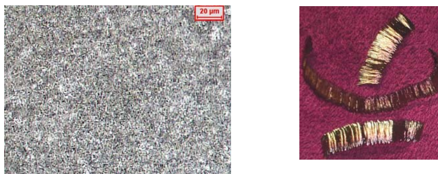
Figura 3. Microestrutura de mesa de cilindro de trabalho para tiras a frio, e cavacos obtidos na usinagem de acabamento.
