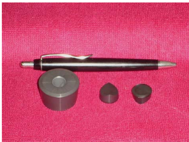
Figura 4. Insertos de geometria RCMA T (à esquerda) e RCGX (à direita, vistas inferior e superior)
