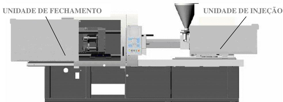
**Figura 1** - Máquina Injetora.
