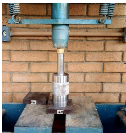
Figura 2. Prensagem uniaxial dos corpos de prova cilíndricos.
