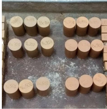
Figura 4. Corpos de prova cilíndricos obtidos por prensagem.
