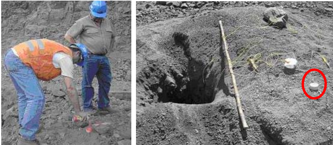
Figura 3. a. Locação de etiquetas na superfície da pilha de material formada após o desmonte; b. Locação de etiquetas nos furos de perfuração.
