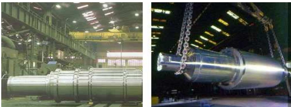
Figura 4 – Cilindros de laminação.<sup>(8)</sup>
