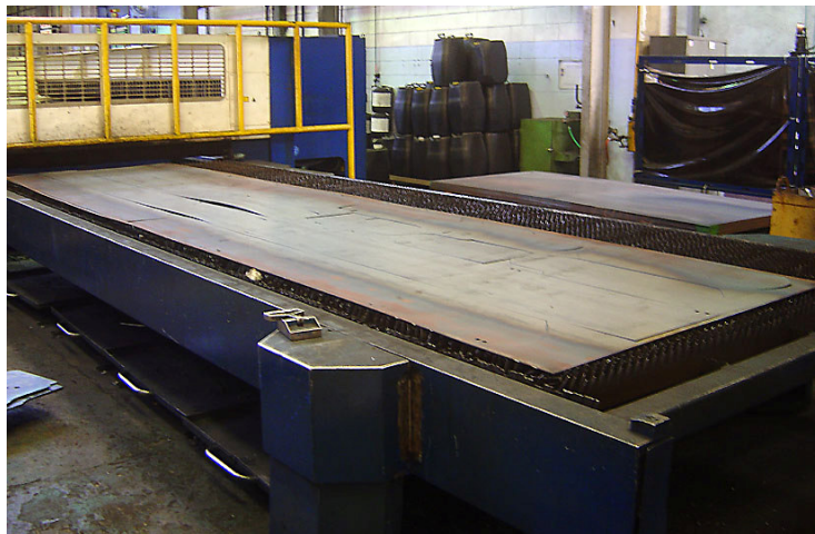
Figura 5 – Ilustração de uma chapa de aço cortada automaticamente. (22)
