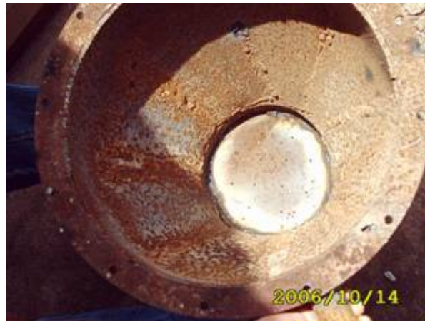
Figura 5 a e 5b - Protótipo Cônico e em detalhe mostrando as ventaneiras.
