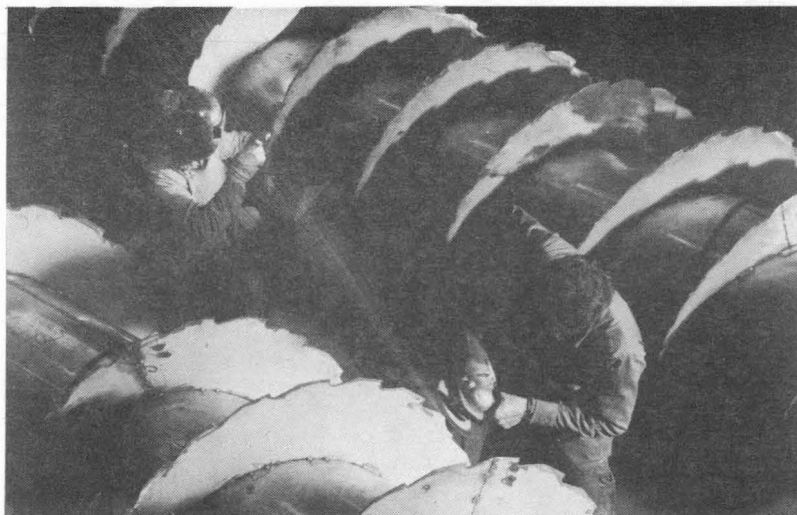
Fig. 12: Rosca Repolpadora construída em aço AISI 304L, para a indústria de papel e celulose
