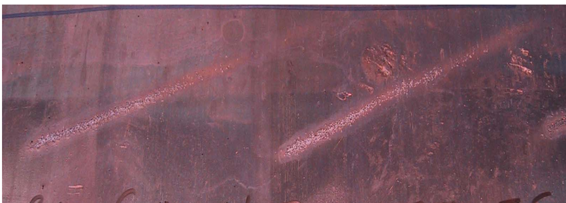
Figura 7. Praticamente desaparece parte da pegada por causa de um excessivo overlap.
