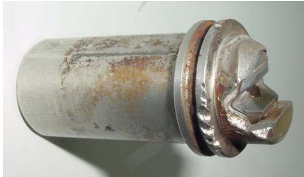
Figura 11. Bico desgastado externamente por um bico do chuveiro oposto.
