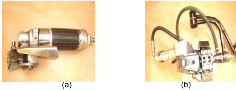
Figura 2. (a) Tensionador pneumático e (b) Ferramenta pneumática conjugada
