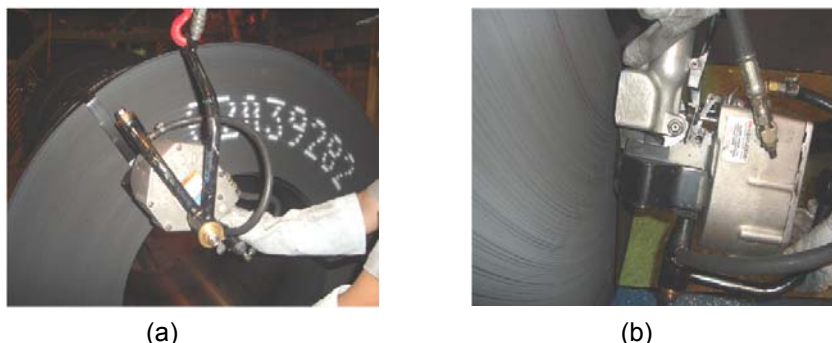
Figura 7. (a) Máquina conjugada e (b) Visão frontal da máquina conjugada (tensionador e selador)
