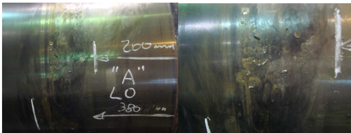
Figura 9 – Superfície dos cilindros Equalizer utilizados na cadeira F7 após campanha de 160 km.
