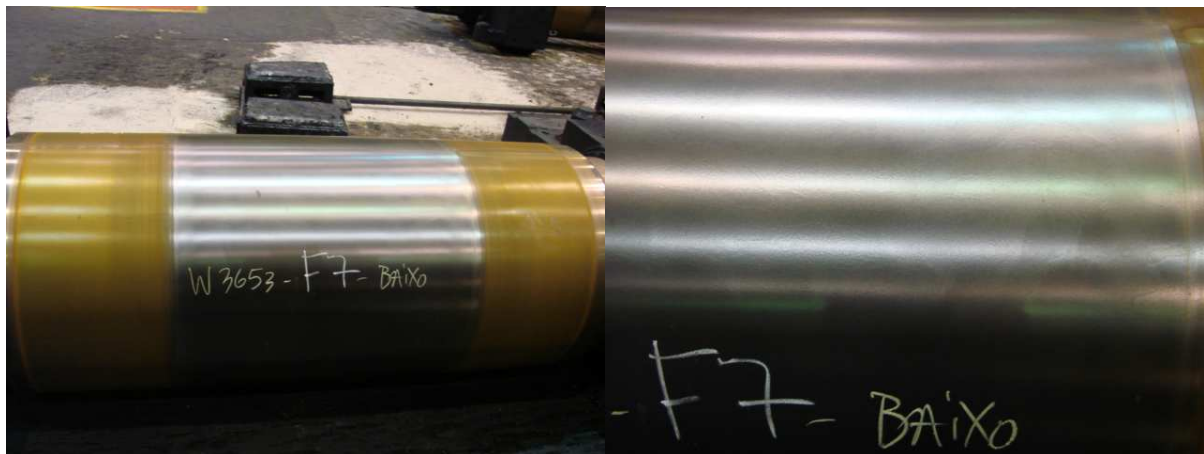
Figura 7 – Superfície dos cilindros Equalizer utilizados na cadeira F7 após campanha de 160 km.
