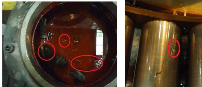
Figura 4. Contaminação – Presença de folha de alumínio dentro dos mancais.
