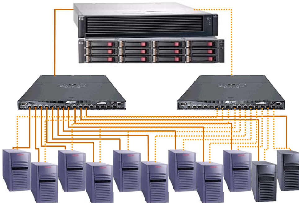
Figura 5. Configuração redundante de sistema de armazenamento externo.
