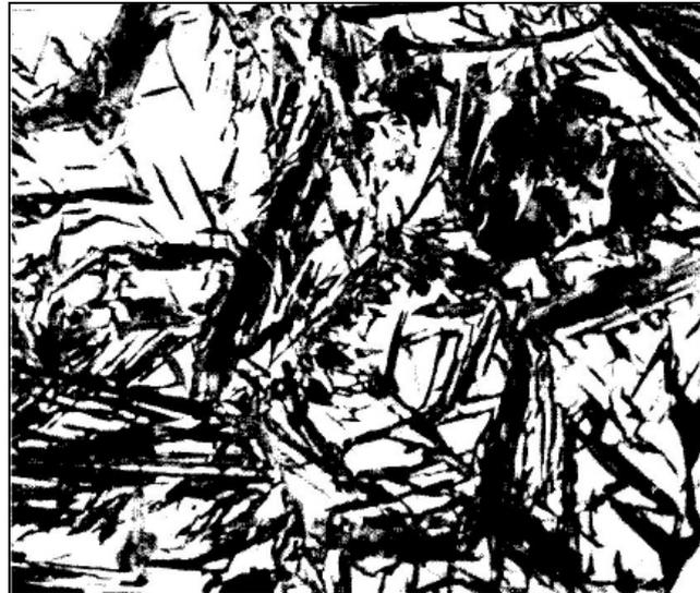
**Figura 2** - Micrografia de martensita (agulhas) e austenita não-transformada (regiões claras) após resfriamento rápido (têmpera).<sup>(4)</sup>
