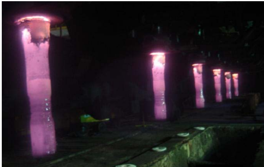
Figura 2: Válvulas submersas após o uso
