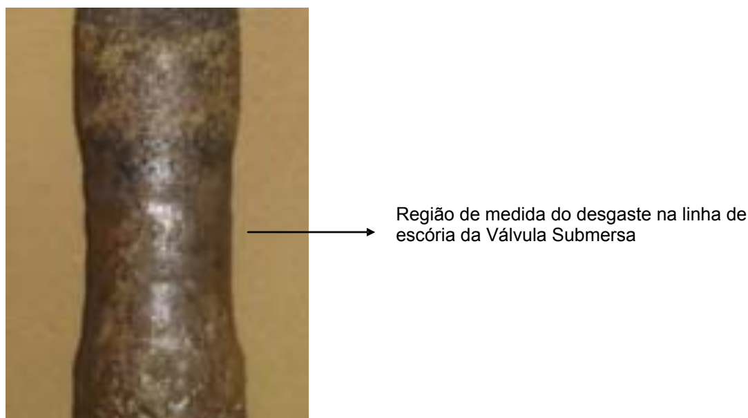
Figura 4: Válvula submersa e região de desgaste.
