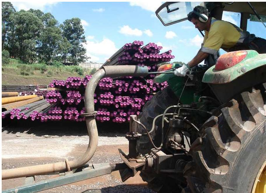
**Figura 4** – Acoplamento do trator ao semi-reboque
