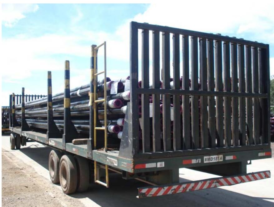
**Figura 5** – Dispositivos de segurança para o transporte de tubos.
