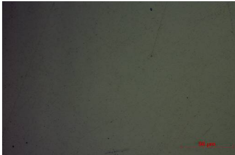
Figura 5 - Aspecto superficial do Inox AISI 316 lixado e polido (amostra 2) em imersão a quente, durante 30 minutos.
