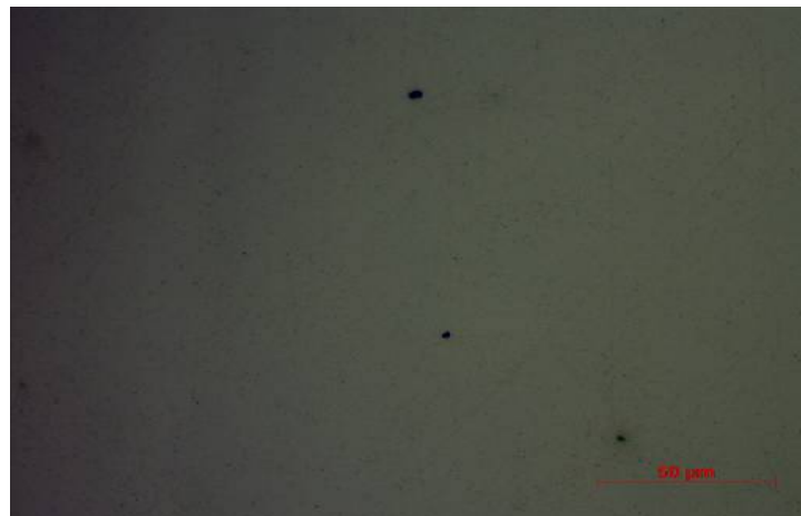
Figura 9 - Aspecto superficial do Inox AISI 316 lixado e polido (amostra 4) em imersão a quente durante 180 minutos.
