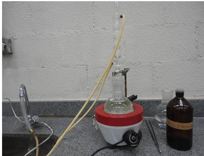
Figura 2 - Equipamento utilizado para os ensaios de imersão a quente.
