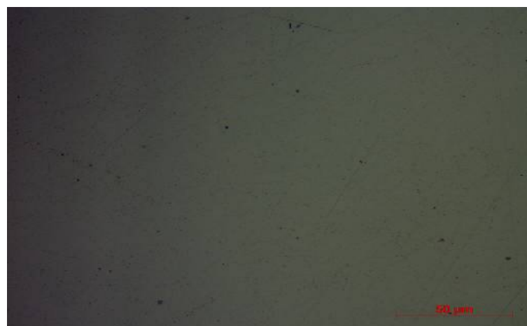
Figura 7 - Aspecto superficial do AISI 316 lixado e polido (amostra 3) em imersão a quente, durante 60 minutos.
