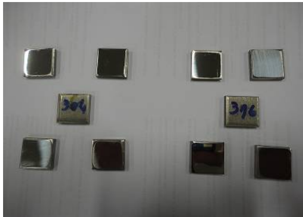
Figura 1 - Amostras lixadas e polidas usadas nos ensaios de imersão.
