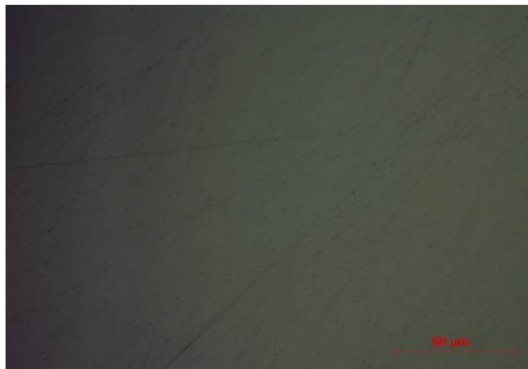
Figura 4 - Aspecto superficial do Inox AISI 304 lixado e polido (amostra 5 - referência).
