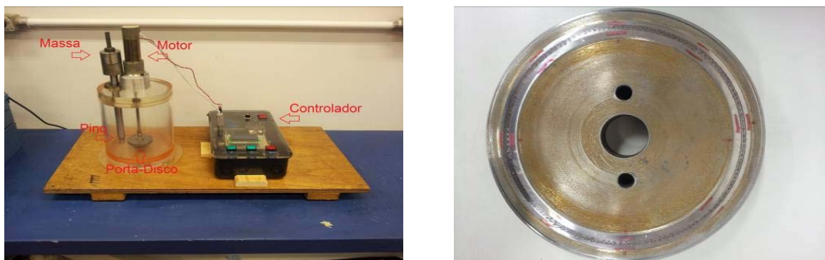
Figura 1 a) Dispositivo de Desgaste do Tipo Pino-Sobre-Disco Utilizado no Estudo; b) Amostra Desgastada de Aço SAE 52100 Esferoidizado
