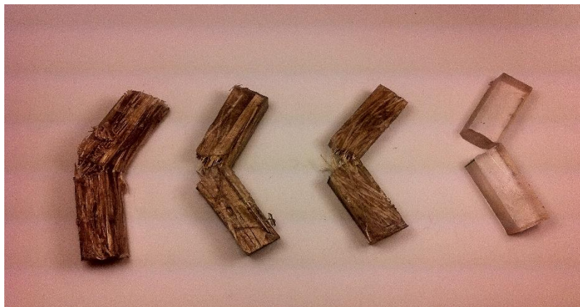
Figura 4. Macrografia das amostras de compósitos epoxy reforçados com manta de malva e juta.
