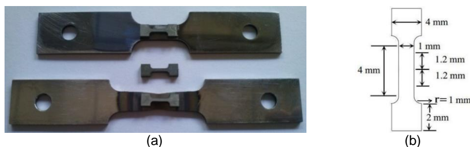
Figura 3. Região de extração dos corpos de prova sub-size para os ensaios de tração. Os corpos de prova maiores foram testados previamente no simulador termomecânico Gleeble3S50TM do LNNano. (b) Dimensões do corpo de prova sub-size .
