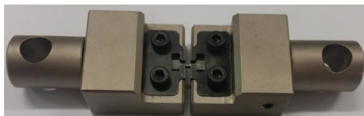
Figura 4. Sistema de garras para realização de ensaios de tração em corpos de prova sub-size .
