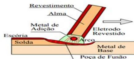
Figura 1. Esquematização do processo SMAW (Eletrodo Revestido) [2].
