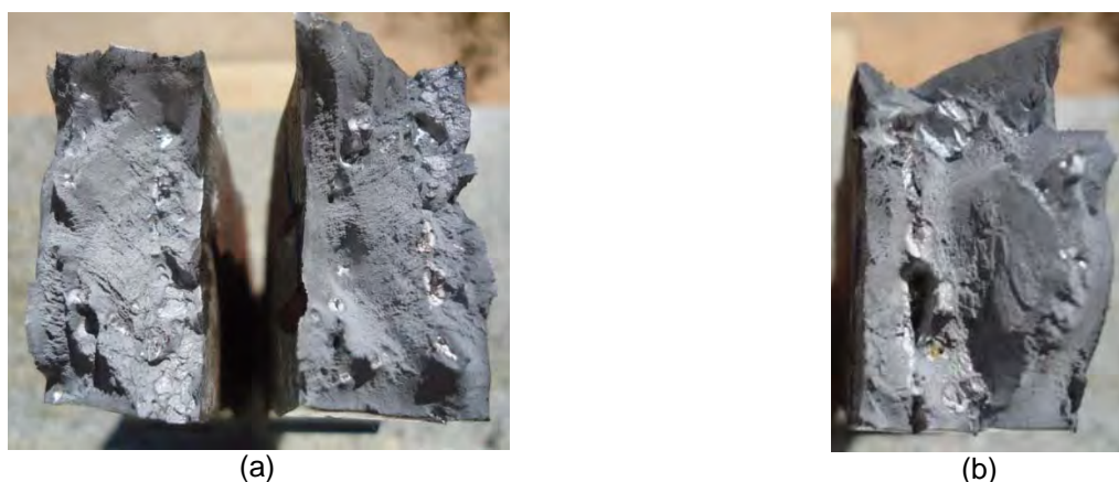
Figura 11 – Macrofratografias da região da solda após ensaio de tração; aço “X52”; (a) superfícies de fratura; (b) destaque da fratura com presença de descontinuidades ("defeitos").
