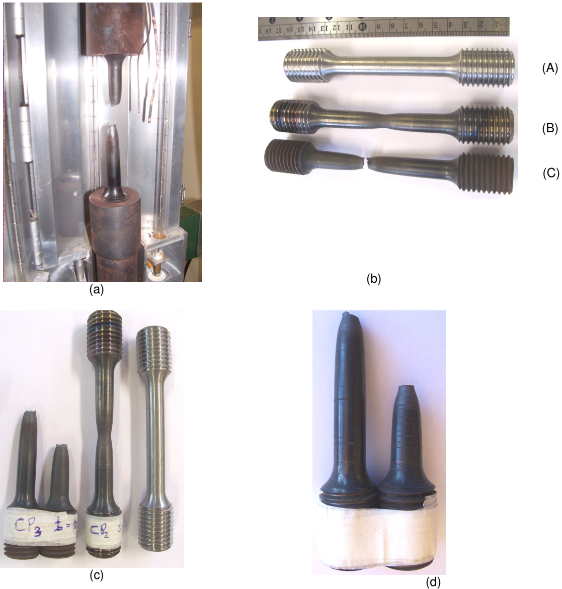
Figura 10 – Corpos-de-prova de ensaios de ruptura por fluência; (a) CP rompido, dentro do forno; (b) e (c) comparação entre um CP não ensaiado (A), e outros ensaiados – (B) não rompido e (C) rompido; (d) detalhe de um CP com fratura do tipo “taça-cone”.
