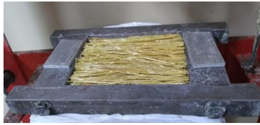
Figura 4. Fibras de tucum acomodadas no molde metálico.
