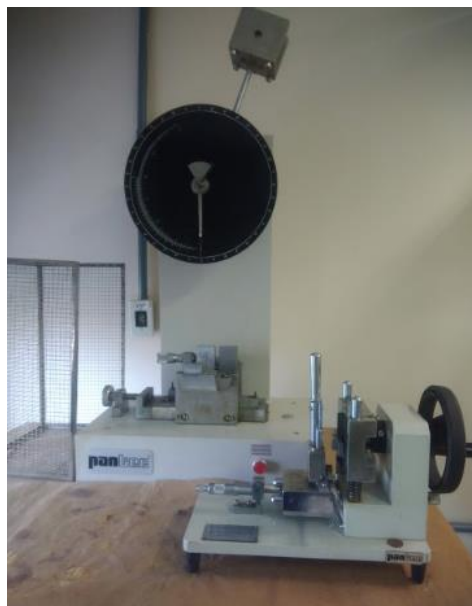
Figura 6. Pêndulo PANTEC IZ/CH-25 utilizado para o ensaio de impacto Izod.
