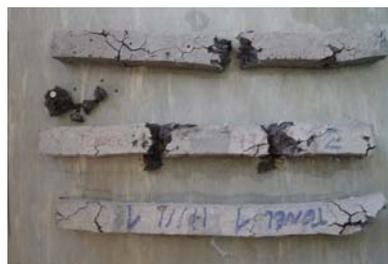
**Figura 2:** Aspecto das barras de argamassa da escória EALD1 após 5 dias de ensaio ASTM C 1260/01
