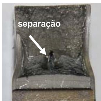
**Figura 9.** Superfície de fratura do corpo de prova SENT.
