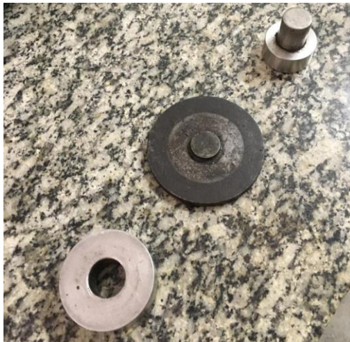
Figura 2: Molde Metálico utilizado na prensagem dos briquetes.
