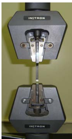
Figura 2: Corpo de prova preso na máquina para ensaio de tração.
