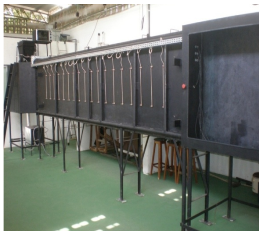
Figura 3: Precipitador Eletrostático Piloto (Canal de Diagnóstico) da K4-Labprec instalado na UFES.
