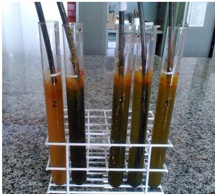
Figura 1: Amostras em meio corrosivo após quinze dias, da esquerda para direita Gupo 2 - Grupo3 – Grupo 1.
