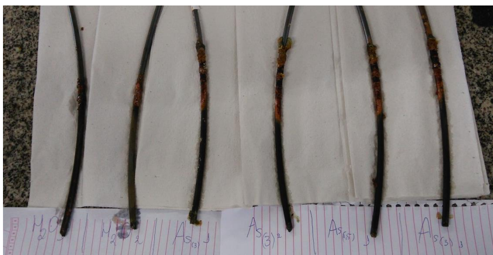
Figura 2: Amostras de aço 1080 após cinquenta dias em processo corrosivo.
