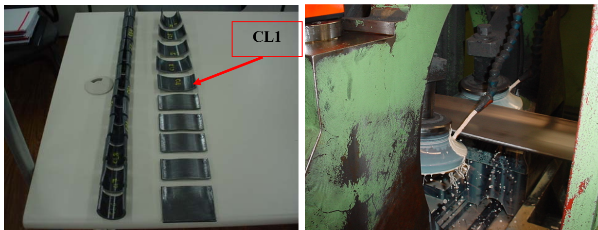
Figura 2. (a) Estágios de conformação do tubos de aço com costura; (b) Matrizes em serviço.
