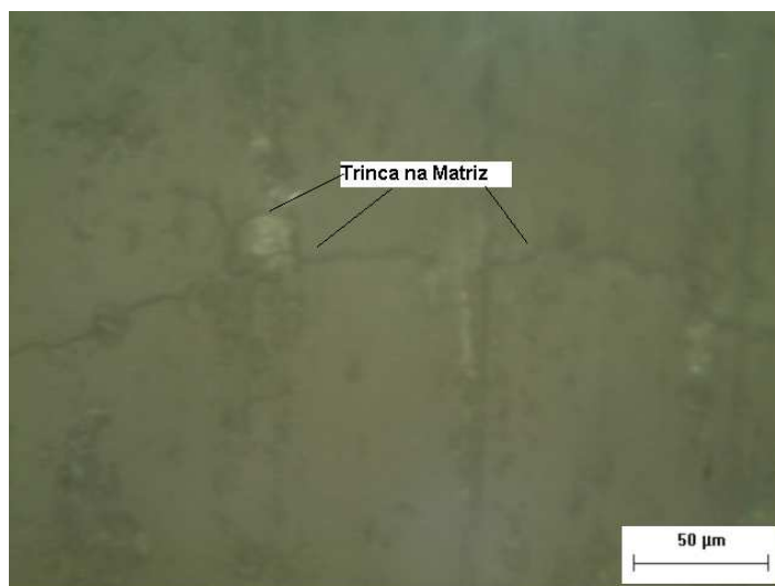
Figura 11. Característica da fratura final do CP após imersão em água do mar.
