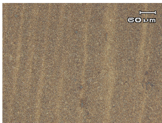
Figura 2- Micrografia do Parafuso - sentido longitudinal do parafuso- aumento 200X
