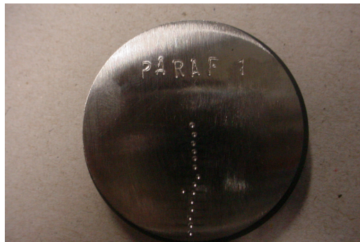
Figura 3- Ensaio de Dureza, espaçamento entre indentações de 1/16 a partir do centro.
