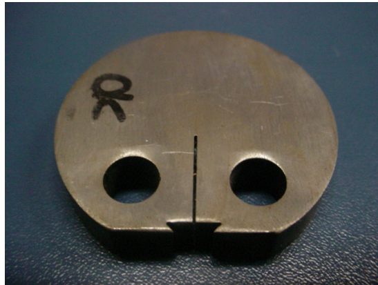
Figura 2- Corpo de prova usinado por eletroerosão
