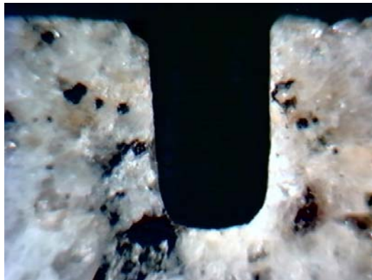
Figura 2. Detalhe do corpo de prova destacando o entalhe, ampliado 10x.
