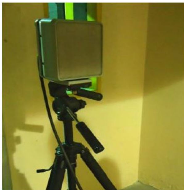
Figura 2. Radar Doppler, modelo SL-520 P, utilizado nessa pesquisa [4].
