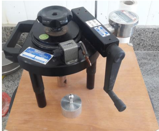
Figura 1 Equipamento utilizado no teste de aderência de tração.
