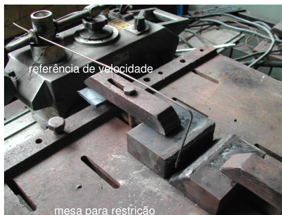
Figura 2. Mesa para restrição das juntas meio-V e sistema de referência de velocidade
