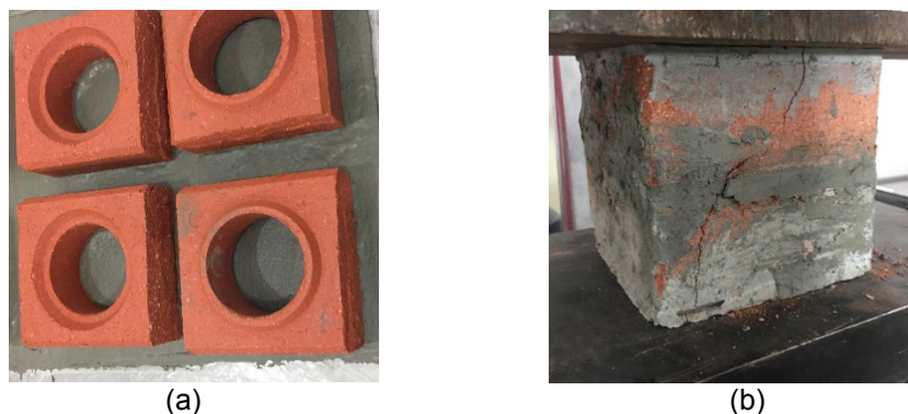
Figura 2 – Ensaio nos blocos: (a) capeamento; (b) bloco ensaiado na prensa EMIC 2000 kN
