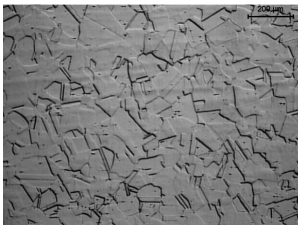
Figura 3. Micrografia ótica com campo polarizado do aço 304 como recebido [3].
