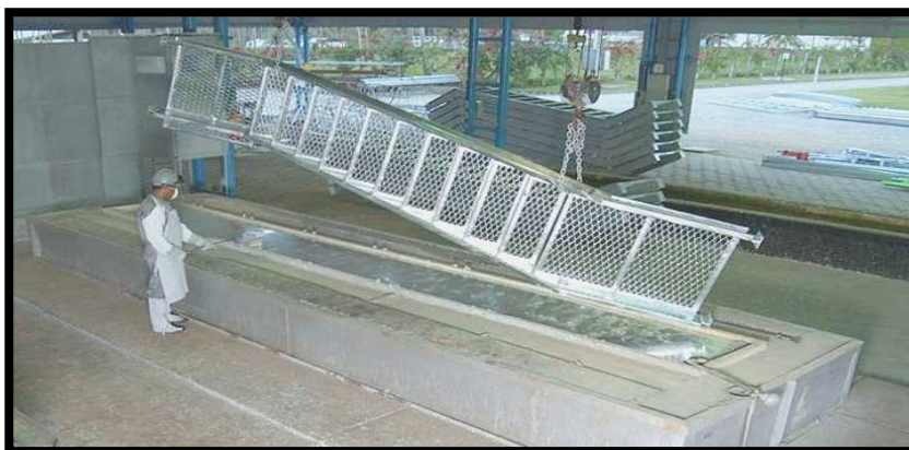
Figura 2: Tanque de imersão com zinco fundido: (1) Deposição em escala industrial; (2) Imersão dos corpos de prova e (3) Remoção dos corpos de prova.
