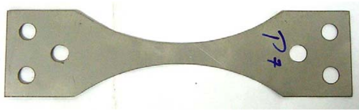
Figura 4 – Foto de um corpo-de-prova para ensaio de fadiga.
